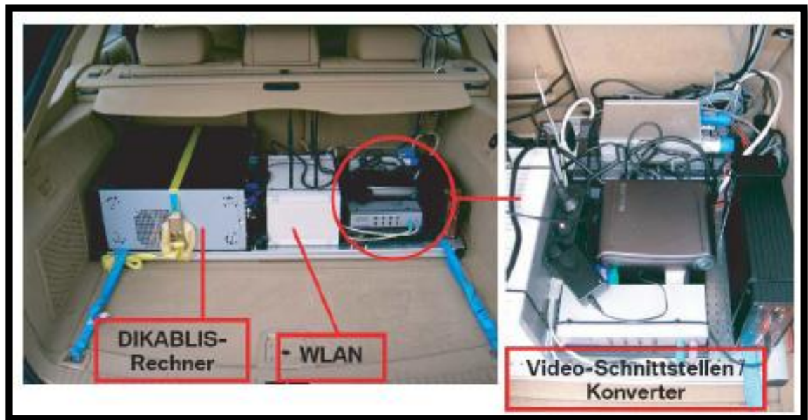
Abbildung 3.4 : Hardwareeinbau im Versuchsträger
