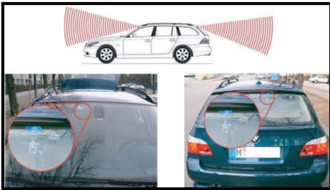
Abbildung 3.9 : Installierte Videokameras zur Überwachung des Verkehrsumfeldes
