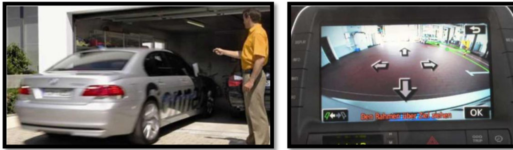
Abbildung 2.7 : Automatisches bzw. semiautomatisches Parkassistenzsystem
