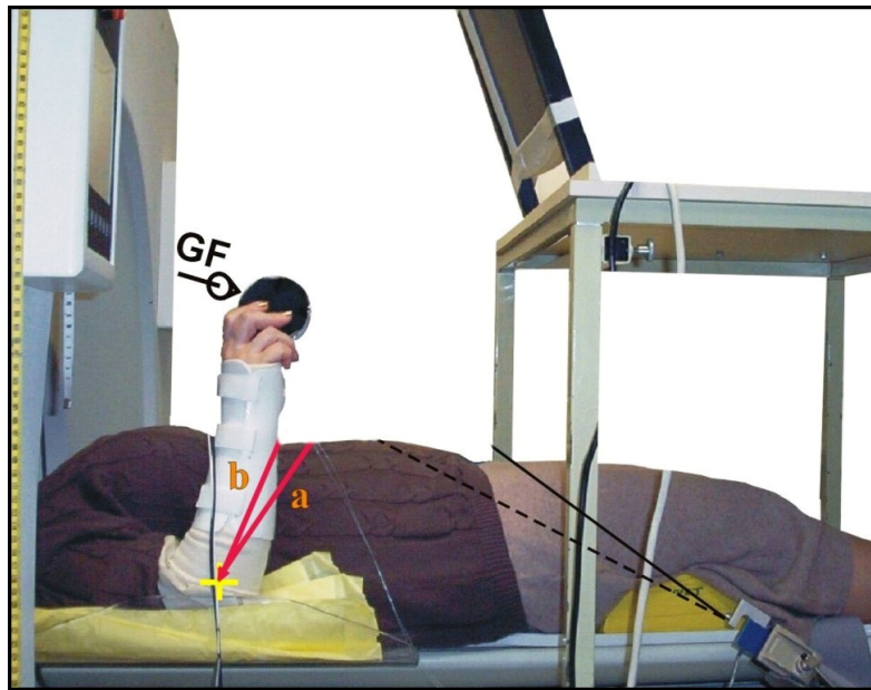
Abbildung 2-12: Versuchsaufbau. Kontrollbedingung (C). Griffkrafterzeugung. Draht nicht mit dem Sensor für LF verbunden. Der Sensor wird wie in Bedingung A mit drei Fingern gehalten. Der Arm ist im Ellenbogen um 90° flektiert
