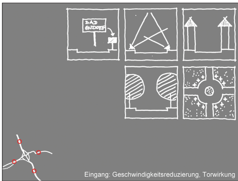
Eingang: Geschwindigkeitsreduzierung, Torwirkung
