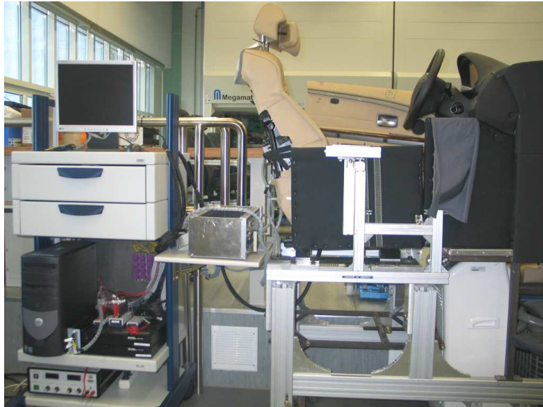
Abbildung 42: Aufbau der automatischen Sitzkomforteinstellung auf dem Mockup
