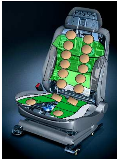
Abbildung 40: Übertragung der Druckverteilung und Einbaulage der „Pneumatiksensoren“
