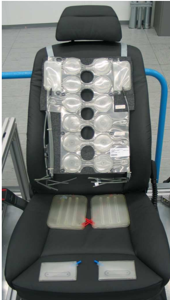
Abbildung 41: Hubelemente, die als Sensoren verwendet werden (Massagematte, Aktivsitzelemente, weiteres Blasenpaar in der STV)
