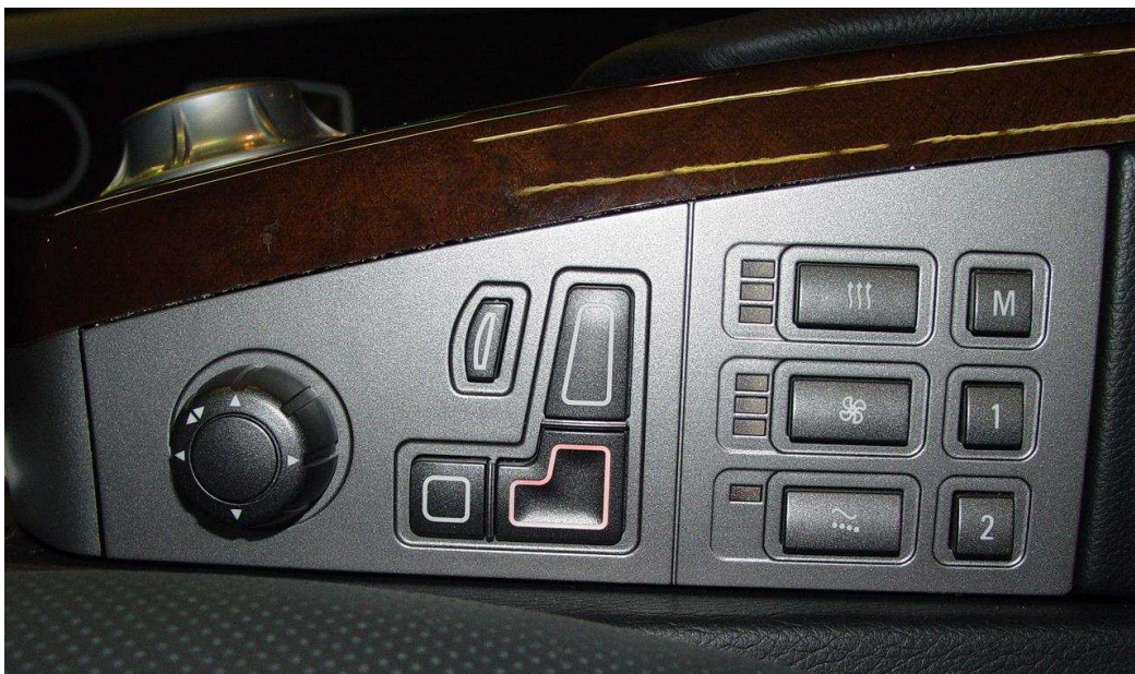
Abbildung 27: Sitzverstellungsschalter 7er-BMW (E65)
