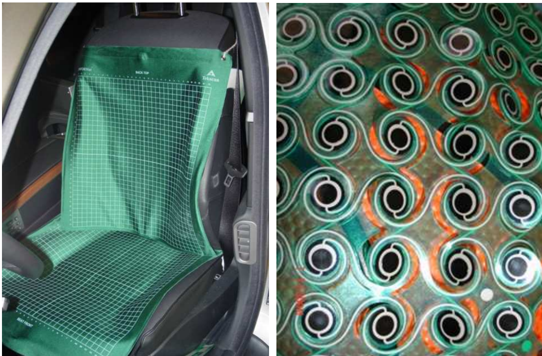
Abbildung 19: ConforMat (links: Messmatten auf Fahrzeugsitz; rechts: Innenansicht)
