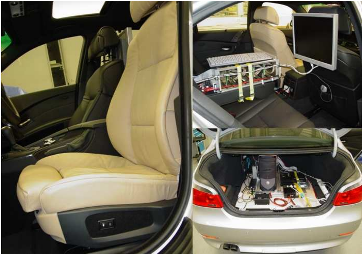
Abbildung 51: Einbau der automatischen Sitzkomforteinstellung ins Versuchsfahrzeug (5er BMW - E60)
