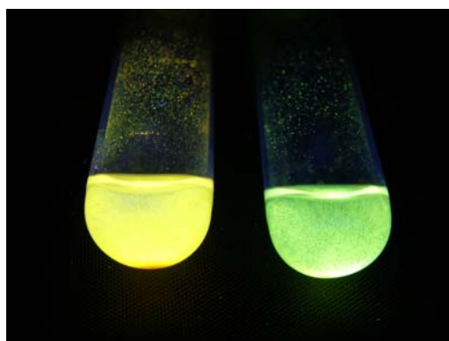
Abbildung 4.44: TDC-MOF-7 im UV-Licht: Vergleich von Suspensionen des as-synthesized TDC-MOF-7 (rechts) und der zersetzten Spezies (links) in Chloroform.
