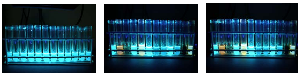
Abbildung 5.17: Referenzversuche mit freiem PyPV: (von links) reiner Linker, Linker direkt nach Zugabe der Testverbindungen, 10 min nach Zugabe.
