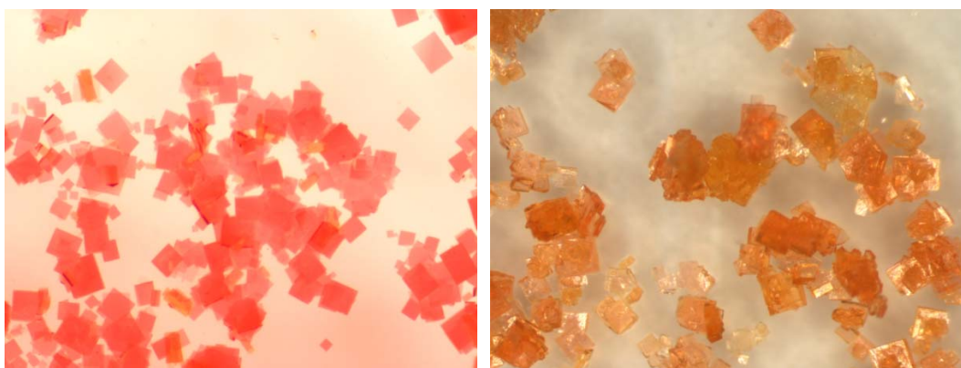
Abbildung 4.41: TDC-MOF-5 (BiPyTz-Pillar) mit unterschiedlichen Anteilen an hydrolysiertem BiPyTz.
