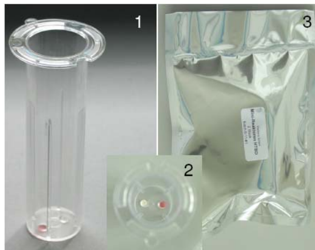
Abbildung 4.1.4: Die Einweg-Bioreaktoren (1) werden als Massenartikel im Spritzgussverfahren aus Polystyrol gefertigt. Nach dem Anbringen der Sensorpunkte (2) werden die Reaktoren verpackt (3) und mittels \beta -Strahlen sterilisiert.
