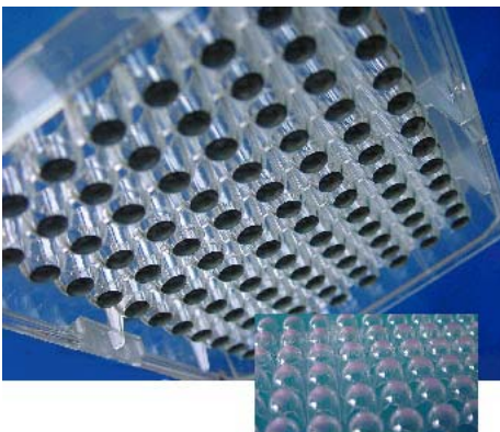
Abbildung 4.1.5: Messprinzip der HydroPlate HP96U (PreSens GmbH). In jeder Kavität ist ein optischer pH-Sensor fixiert. Die Sensoren werden im MTP-Fluoreszenzphotometer ausgelesen.
