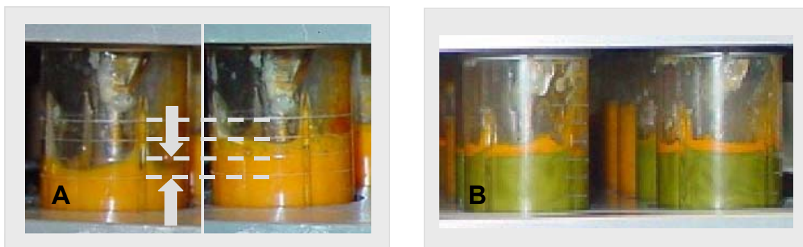
Abbildung 5.3.1: Verschiedene visuelle Anzeichen für den Zusammenbruch der Gasversorgung in den Milliliterreaktoren: (A) Links ist das Absinken des Füllstandes und Ausbleiben von Blasenbildung gezeigt. Der rechte der beiden Reaktoren verfügt über eine intakte Gasversorgung, während der linke die beschriebenen Anzeichen aufweist. (B) Bei anderen Reaktoren desselben Versuches die Grünfärbung der Kulturbrühe zu beobachten. Auch hier ist keine Blasenbildung im Reaktor zu erkennen.
