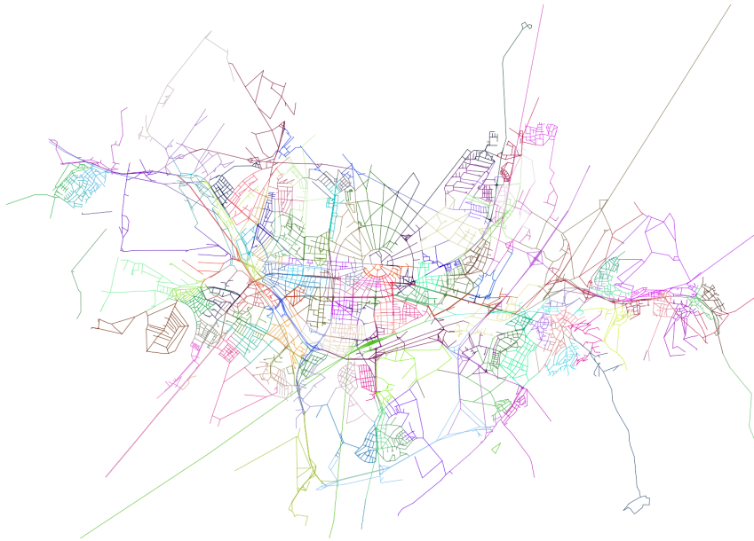
Abbildung 7.16: 128 Partitionen nach der Anwendung der Multilevelpartitionierung mittels ParMETIS auf das Verkehrsnetz von Karlsruhe.
