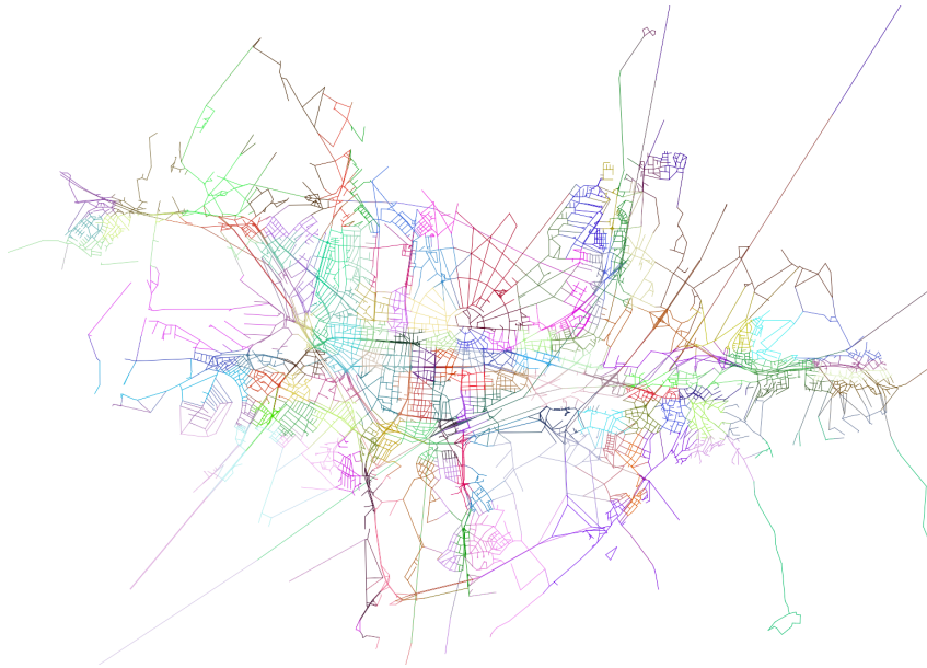
Abbildung 7.12: 128 Partitionen nach der Anwendung der rekursiven Koordinatenbisektion auf das Verkehrsnetz von Karlsruhe.
