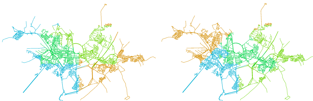
Abbildung 5.21: Partitionierung des Stadtnetzes von Karlsruhe mittels Sierpinski (links) und Hilbert (rechts) in vier Teile. Die unterschiedlichen Farben stellen die verschiedenen Partitionen dar.
