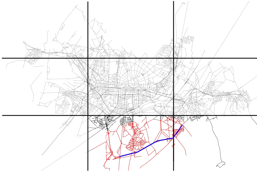
Abbildung 7.21: An der Suche einer Route beteiligte Partitionen im Karlsruher Verkehrsnetz: Die gefundene Route ist blau markiert, die roten Strecken stellen den betrachteten Suchbaum dar.
