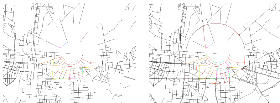
Abbildung 9.4: Gekoppelte Simulation des Karlsruher Verkehrsnetzes unter Verwendung einer Split-Geschwindigkeit von 40 km/h und einer Länge der Zeitscheiben von 30min: Integrierter Ansatz (links) und mikroskopische Referenzsimulation (rechts).
