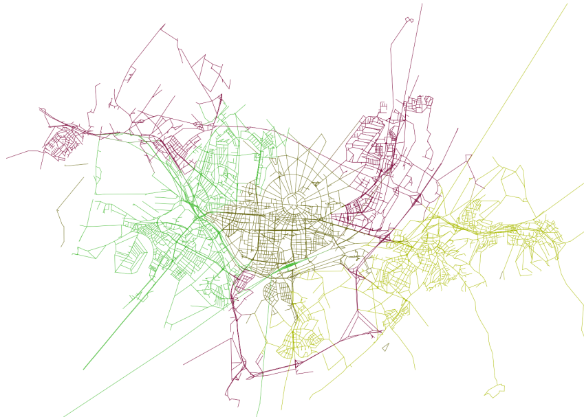
Abbildung 7.15: Vier Partitionen nach der Anwendung der Multilevelpartitionierung mittels ParMETIS auf das Verkehrsnetz von Karlsruhe.
