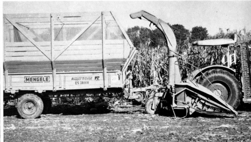
Bild 8: Anbau-Trommel-Feldhäcksler (Vorschlag Landtechnik Weihenstephan) für Einachser (z. B. Stallmiststreuer, Ladewagen) oder Zweiachser (z. B. Automatikwagen). Pick-up-Aufnehmer anklappbar, Maisschneidwerk in Straßenfahrbreite.
