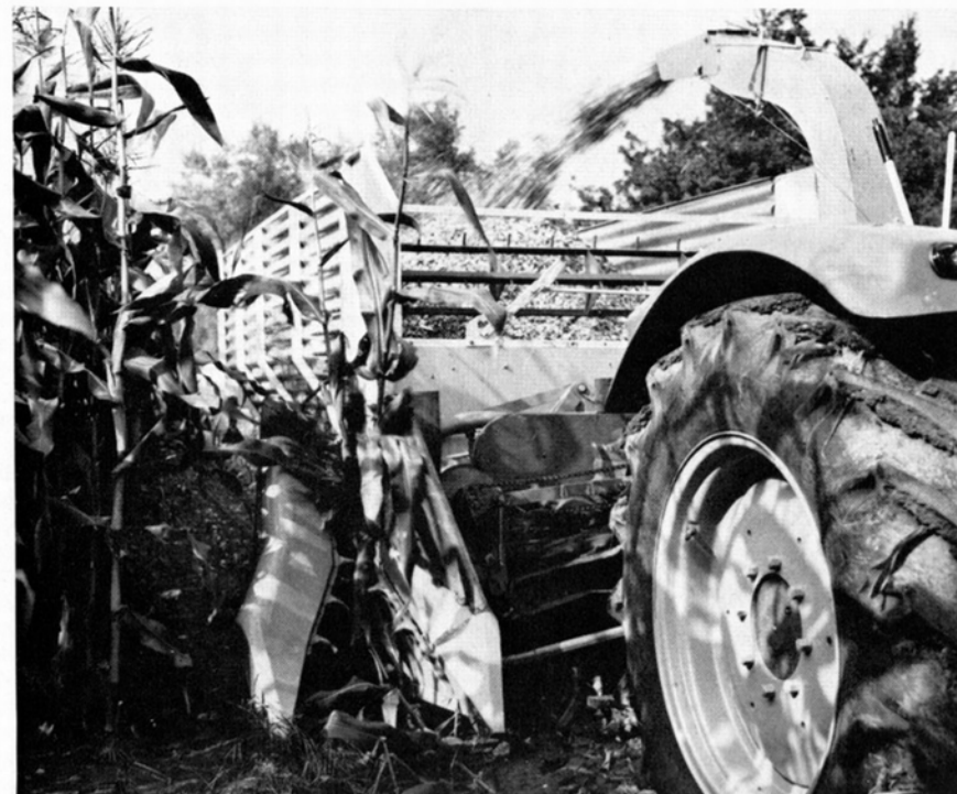
Bild 6: Einbau-Trommel-Feldhäcksler Speiser Rapido in Silomais, Ausleger einklappbar.
