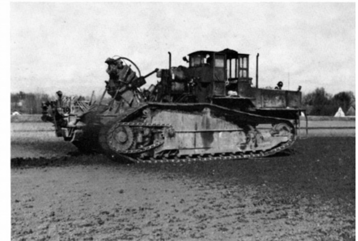
Abb. 14 Untergrundförderer im Einsatz auf Lößboden (Parabraunerde).
