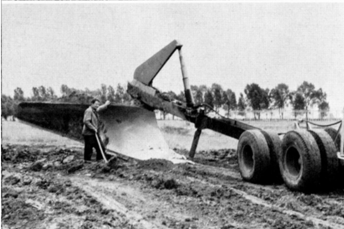
Abb. 12 Tiefpflug mit maximalem Tiefgang von 1,70 m.
