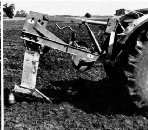
Abb. 6 Untergrundlockerer „Würger 90“ mit Ziehkegel und Steinauslöser — 90-PS-Schlüterzugmaschine.
