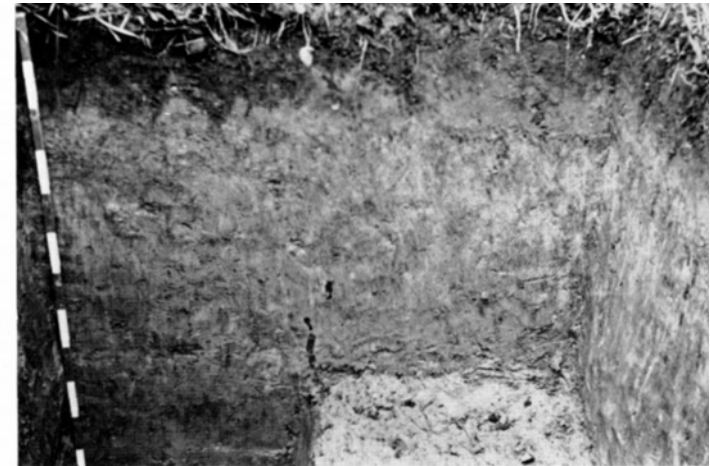
Abb. 1 Verdichteter und staunasser, aber noch entwicklungsfähiger Ackerboden (Pseudogley)
