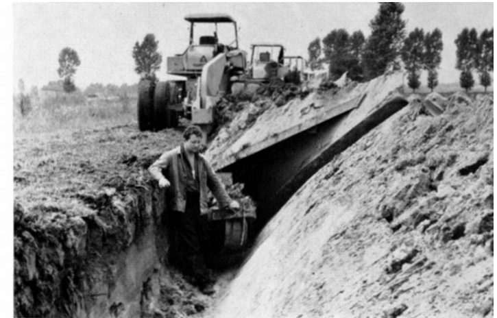
Abb. 13 Tiefpflug im Einsatz auf einem stark degradierten Mineralboden (Pseudogley).
