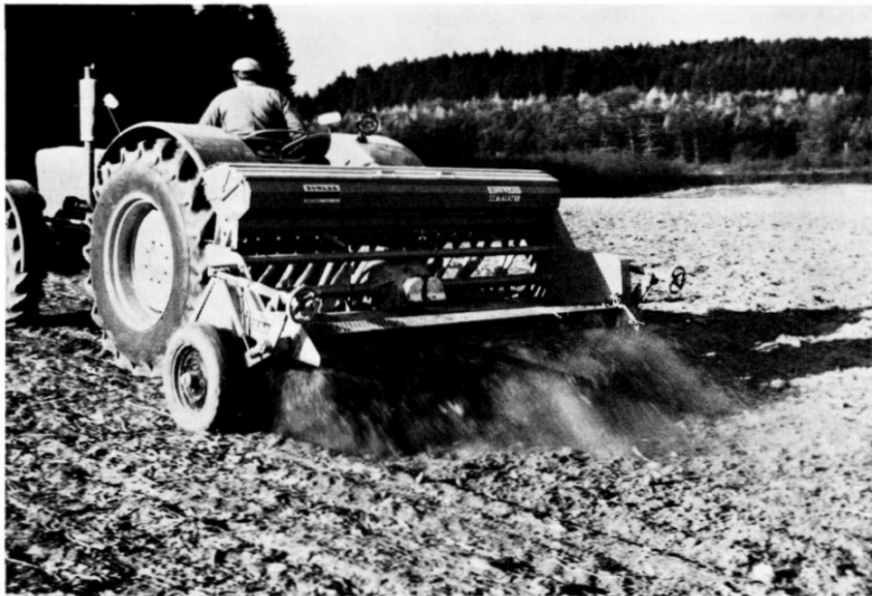
Bild 4: Bodenbearbeitung und gleichzeitige Weizeneinsaat im „Fräsdill-Verfahren“.
