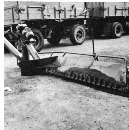
Abb. 3: Aufsammlerschnecken nehmen den Dünger aus ebener Betonfläche selbsttätig auf. Bei diesem System bewegt sich die Zufuhrschnecke im Halbkreis um die Förderschnecke. Der Vorschub wird von Hand bedient. Damit können mehlartige und gekörnte Schüttgüter aufgenommen werden.
