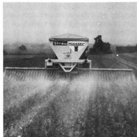
Abb. 6: Bei den Schneckenstreuern wird der mehlförmige Dünger über die Schnecken verteilt und aus 40–60 cm Höhe abgeworfen.
