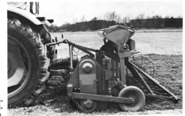
Abb. 4: Die Frässaat kann in Verbindung mit starken Schleppern ein leistungsfähiges Arbeitsverfahren sein.
