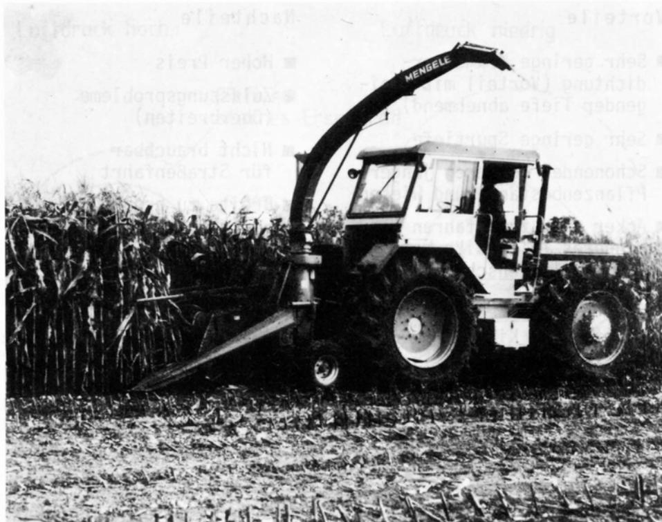
**Bild 3:** Moderner Traktor mit Rückfahreinrichtung (Werkbild Schlüter)
