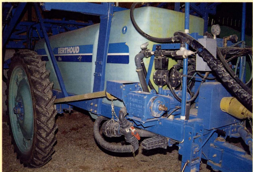
Auch ohne die elektronische Steuerung kann Muhr mit der angehängten Pflanzenschutzspritze die Spritzbrühe abhängig von der zurückgelegten Wegstrecke ausbringen. Die Pumpe wird dabei von der Radachse über einen Zapfwellenantrieb angetrieben und geregelt.
