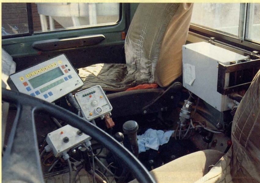
Die Rechnereinheit ist fest an der Kabinenrückwand des Unimogs montiert. Display und Regler sind in Sicht- und Griffweite des Fahrers angebracht.
