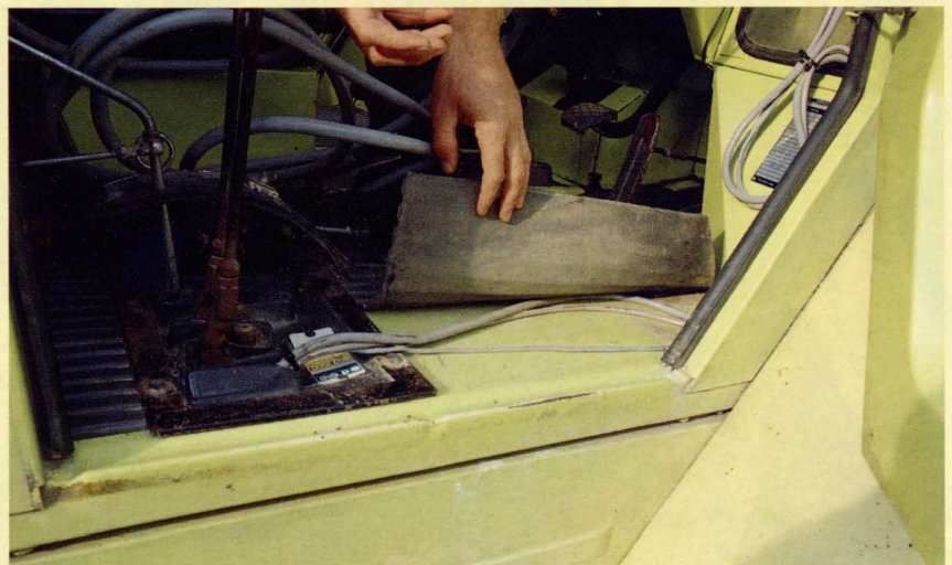
Täger-Farny ärgert sich, daß es schlepperseitig keine Einbauvorkehrungen für Bordrechner gibt und deshalb alle Kabel provisorisch verlegt werden müssen.
