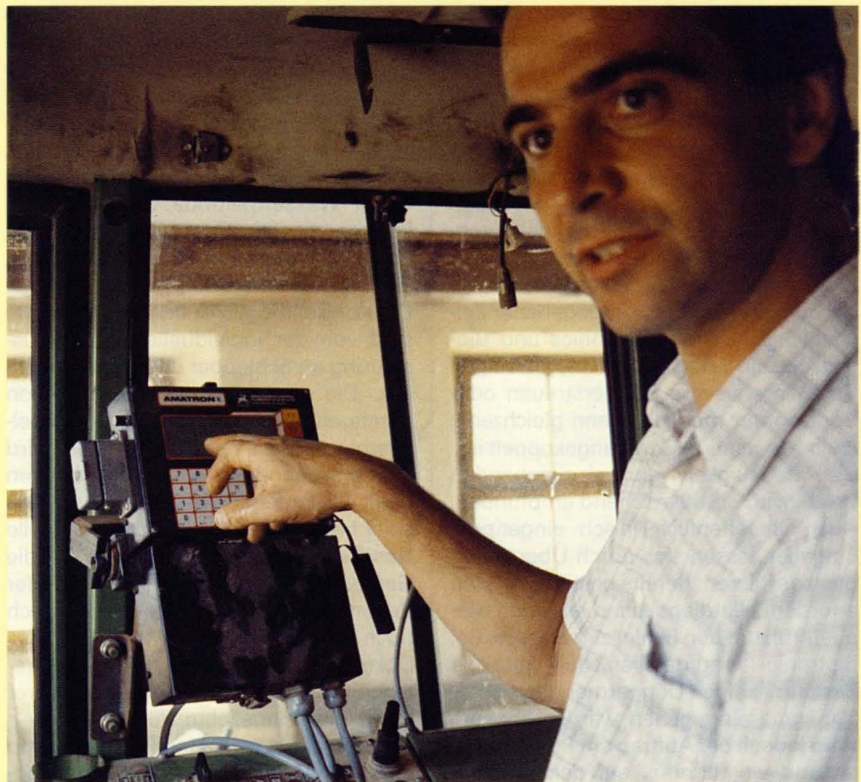
Die Chipkarte wird vor Auftragsbeginn in das Schreib- und Lese-modul des Bordrechners eingesteckt. Per Knopfdruck können die gespeicherten Daten nochmals überprüft werden.
