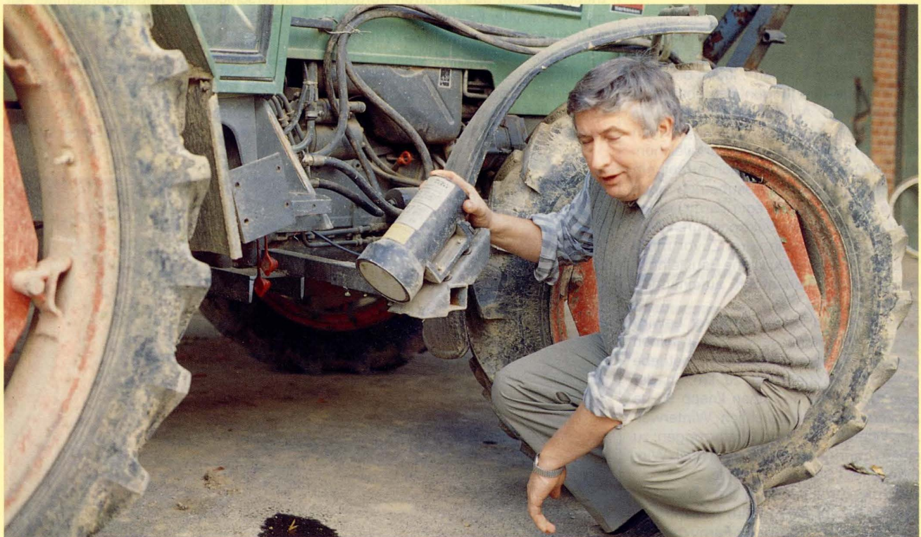
Damit der Radarsensor auch im Bestand unverfälscht die Geschwindigkeit mißt, ist es laut Fritz Söffker wichtig, daß er genau in Höhe der Fahrspur angebracht ist.
