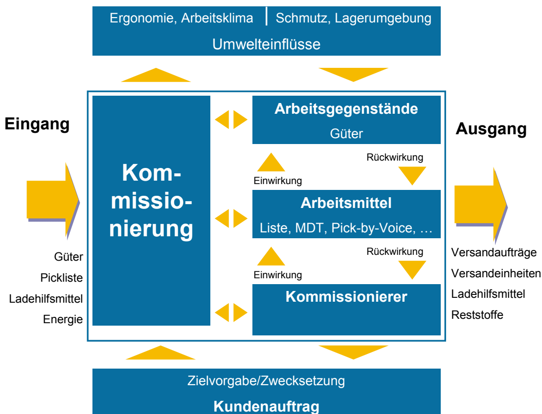
Abbildung 2-7: Das Kommissioniersystem als Arbeitssystem (nach [DIN6385])
