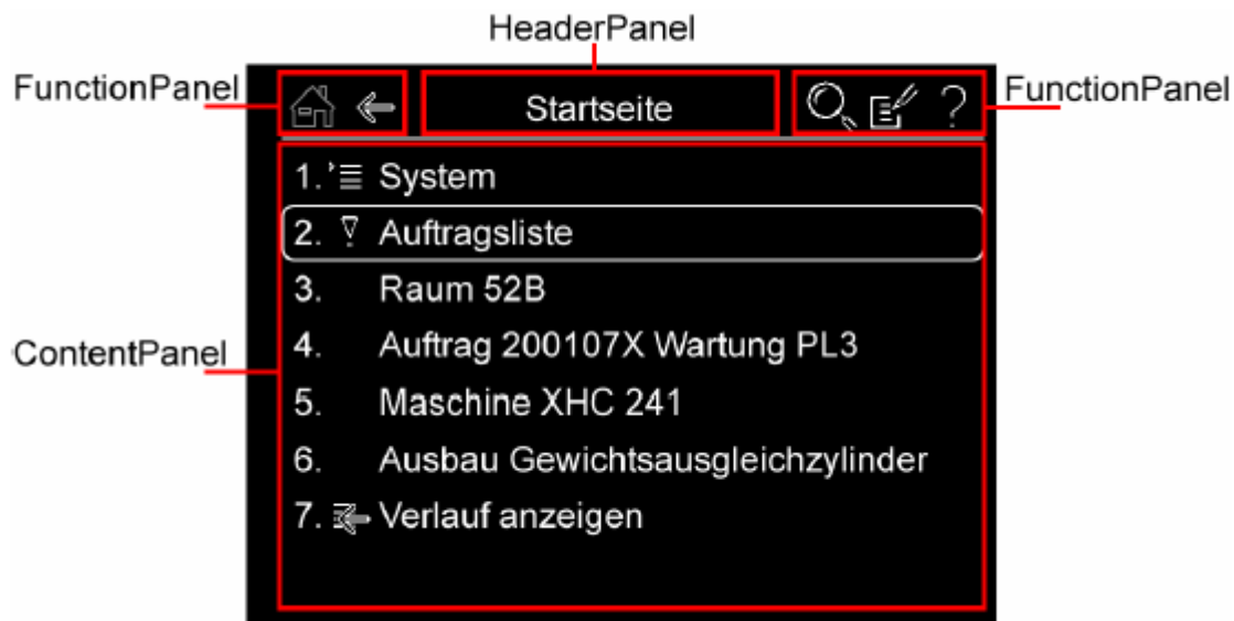
Abbildung 6-14: Generelle Aufteilung der Daten in Inhalt und Navigation bei der Darstellung mit einem HMD [Beu-04]
