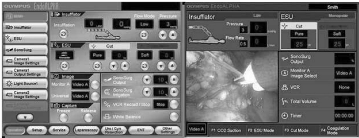
Abbildung 3.7: Benutzeroberfläche eines endoskopischen Operationssaals der Firma Olympus. Neben dem Livebild und der Anzeige verschiedener Vitalparameter kann der Chirurg auf der linken Seite der Software die OP-Infrastruktur steuern (Wong et al. , 2006).
