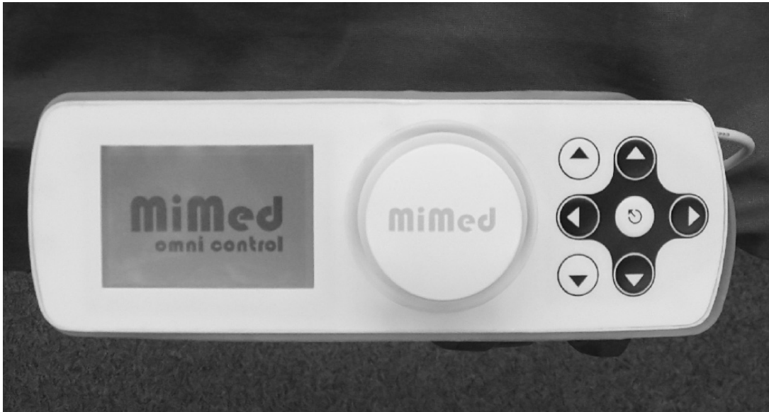
Abbildung 11.8: Realisierung des Eingabegerätes OmniControl. Das Gerät wird über eine Halterung am OP-Tisch eingeklickt und per USB an die Verschaltungsmatrix der Eingabegeräte angeschlossen. Im sterilen Umfeld wird das Eingabegerät in einer sterilen Folie verpackt.
