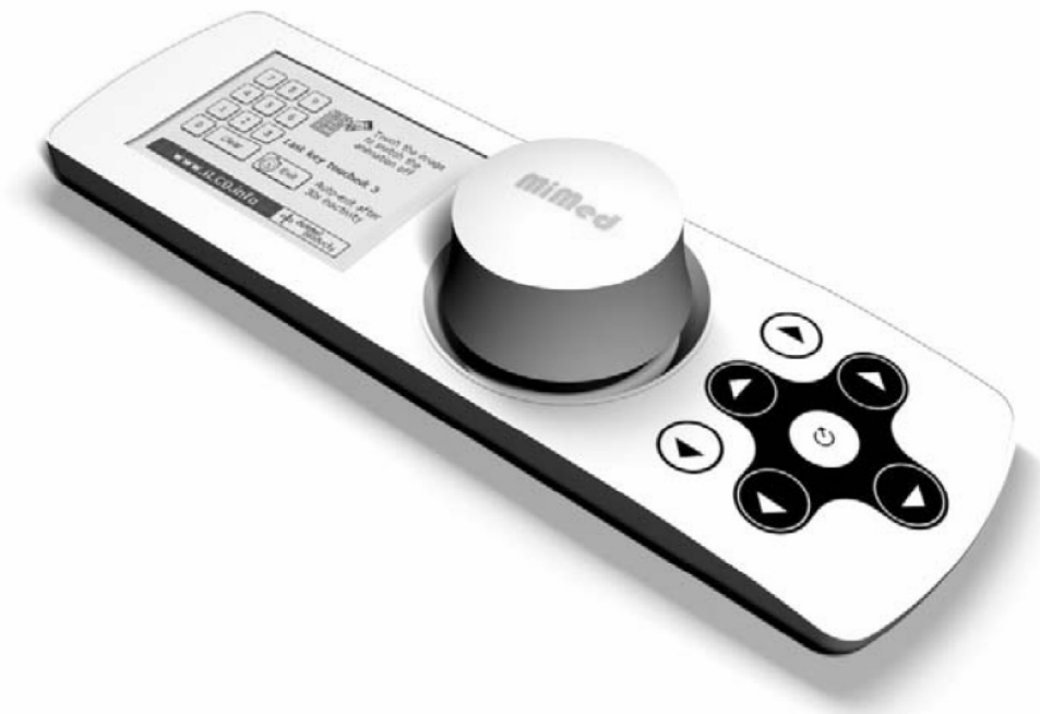
Abbildung 10.4: Dreidimensionales Modell des konstruierten Eingabegerätes. Es besteht im linken Teil aus einem Touchdisplay, in der Mitte aus einer 6D-Maus und im rechten Teil aus einer Folientastatur.
