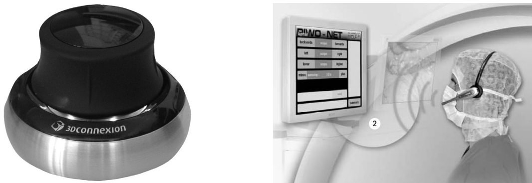
Abbildung 3.9: Eine 6D-Maus zur Manipulation von 3D-Daten (Quelle: 3dconnexion); b) Sprachsteuerung über ein Mikrophone (Quelle: Richard Wolf, 2008).
