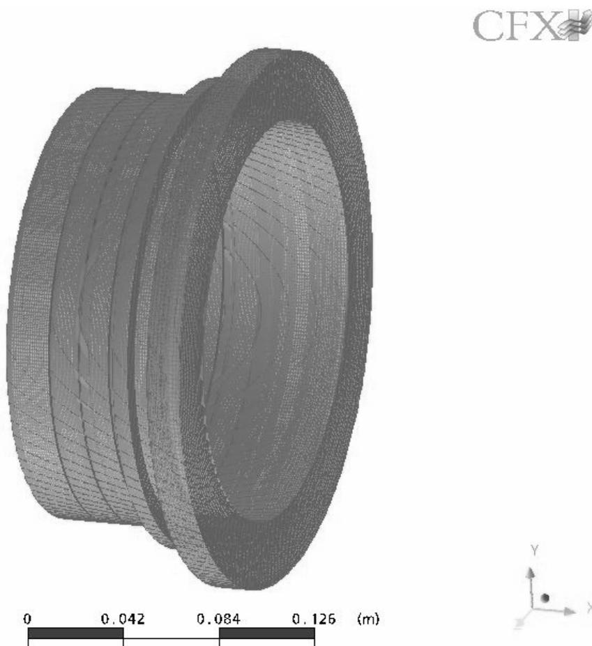
**Bild 6-1** Blockdarstellung des Strömungsraumes für die Berechnung
