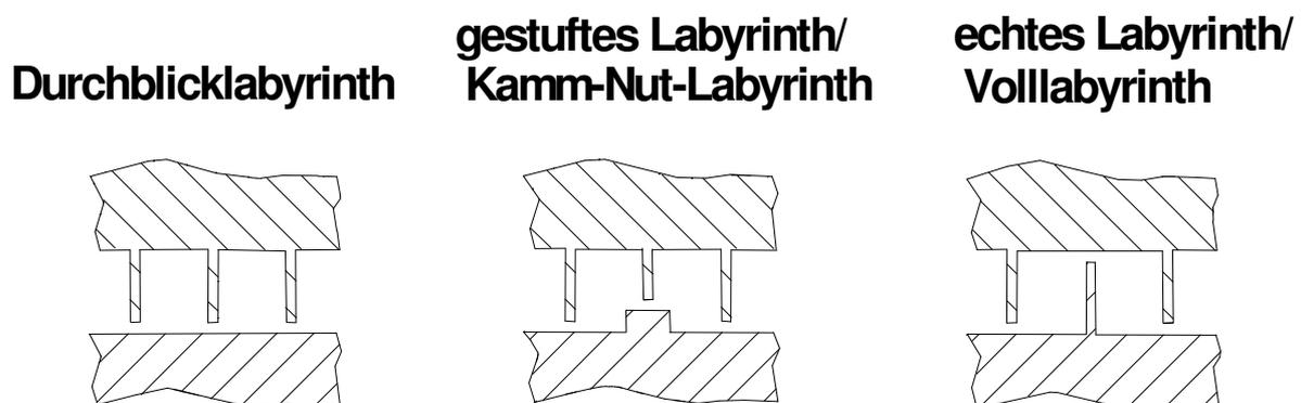
**Bild 2-1** Grundlegende Bauformen von Labyrinthdichtungen
