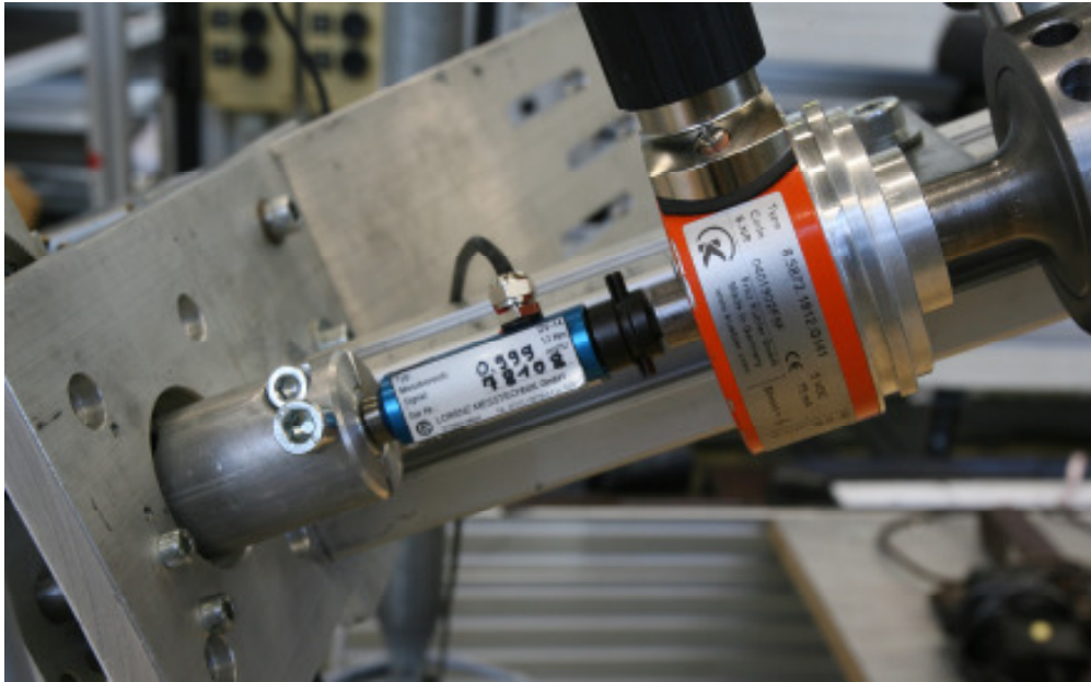
Abbildung 164: Drehwinkelsensor (optisch) und Drehmomentsensor (links im Bild) zur Messung von Lenkmoment und Lenkwinkel
