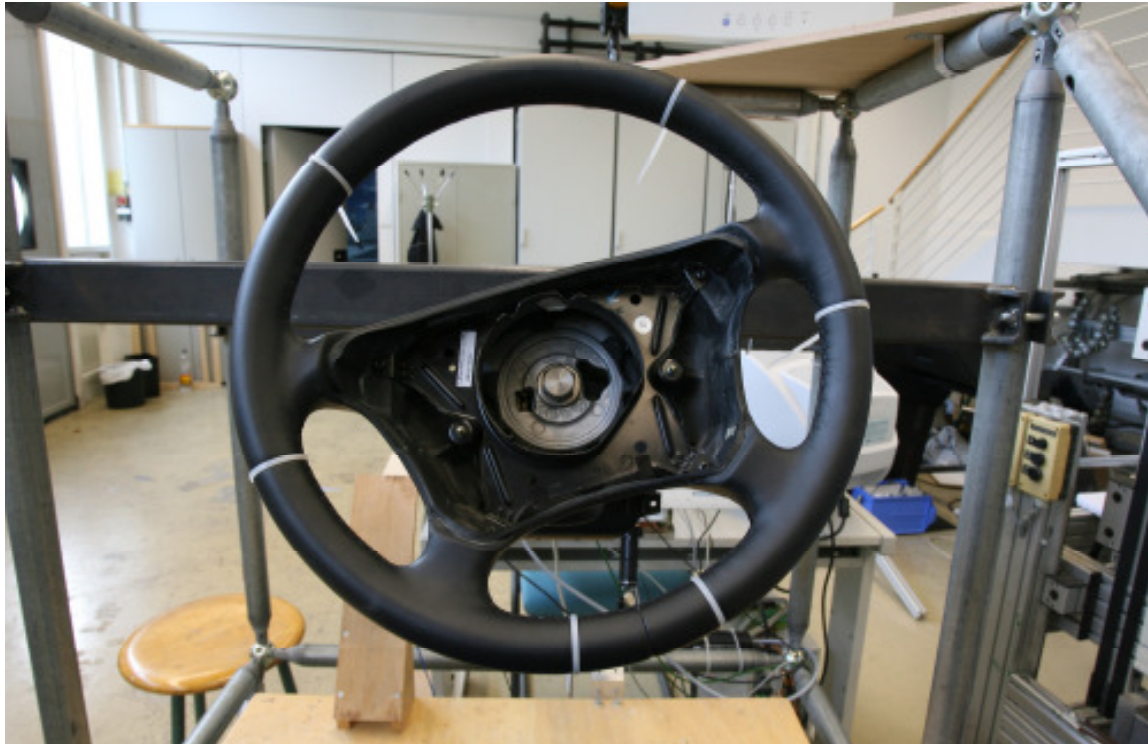
Abbildung 167: Markierungen für drei unterschiedliche Handhaltungshöhen (oben, Mitte, unten) am Lenkrad bei denen die Wahrnehmungsschwellen gemessen werden (die Markierung bezieht sich auf die Handunterkante)
