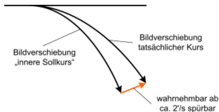
Abbildung 125: Abweichung der Bildverschiebung eines im Horizont liegenden Bezugspunktes gegenüber dem vom Fahrer festgelegten „inneren“ Sollkurses
