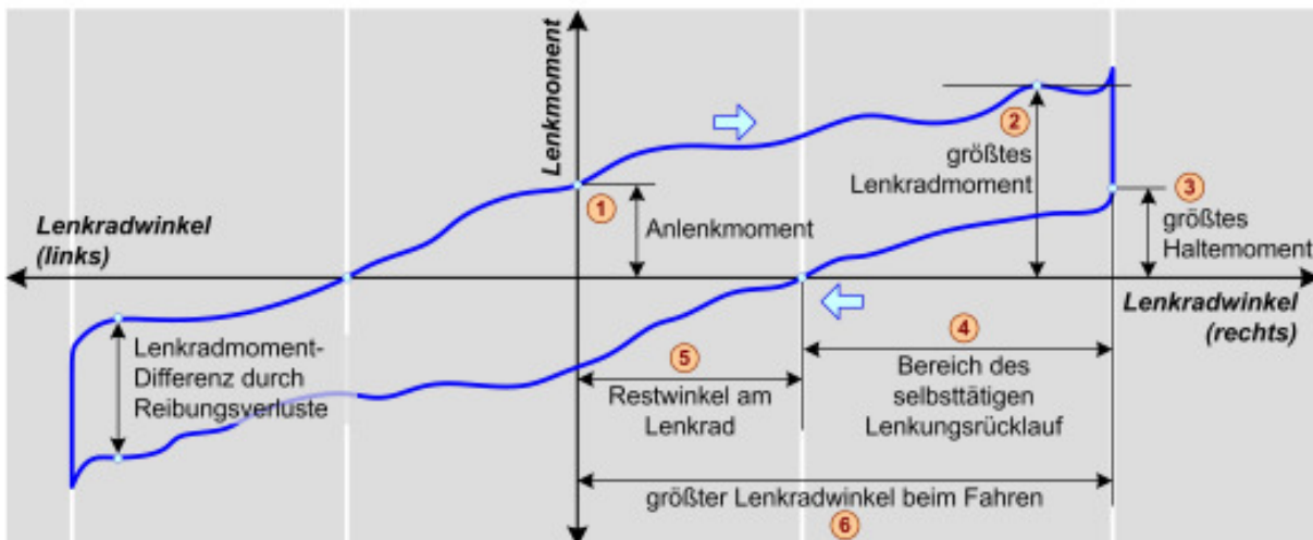
Abbildung 8: Typische Merkmale einer Lenkmoment-Lenkwinkel-Hysterese
