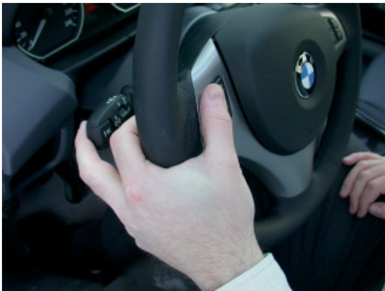
Abbildung 141: Typische Handhaltung der linken Hand bei Bedienung von Blinkerhebel mit Zusatzfunktion und Lenkradtasten
