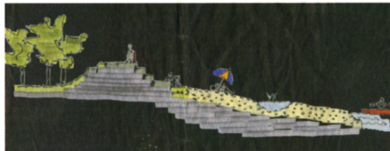
Kultur, Sport und Naherholung – das sind die Merkmale von Donau, Inn und Ilz. Diesen Grundgedanken folgend, werden die Uferstreifen entsprechend gestaltet. Die Skizze zeigt das vom Bahndamm zum flachen Aktivband umgebaute rechte Inn-Ufer, an dem Sportboote festmachen können und Badegäste verweilen. Auch die anderen Flussufer werden von vielen Seiten zugänglich gemacht und entsprechend ihrer Merkmale gestaltet.
