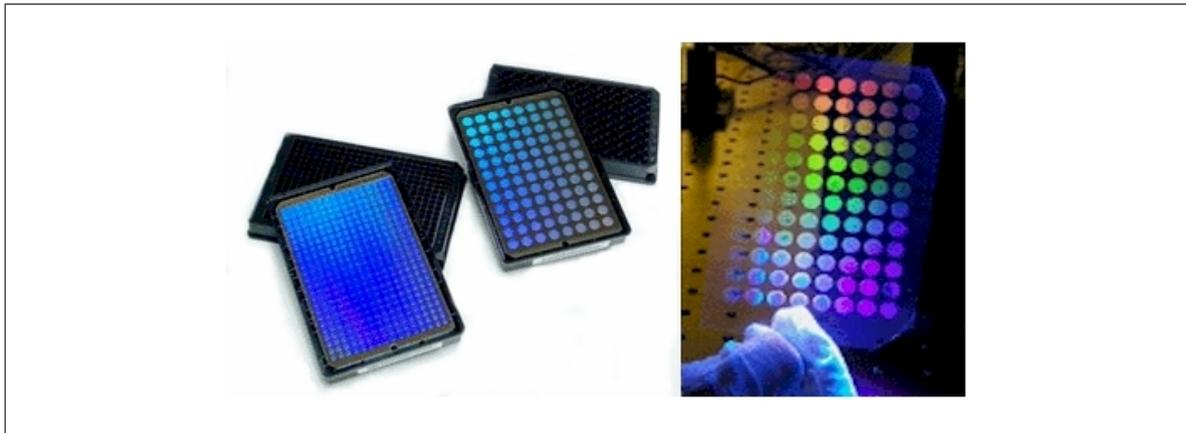
**Abbildung 3.7:** Sensorbeschichtete Multiwellplatten (96 und 384) des Herstellers SRU Biosystems aus den USA. Quelle: SRU Biosystems, Internetauftritt: [www.srubiosystems.com](http://www.srubiosystems.com)
