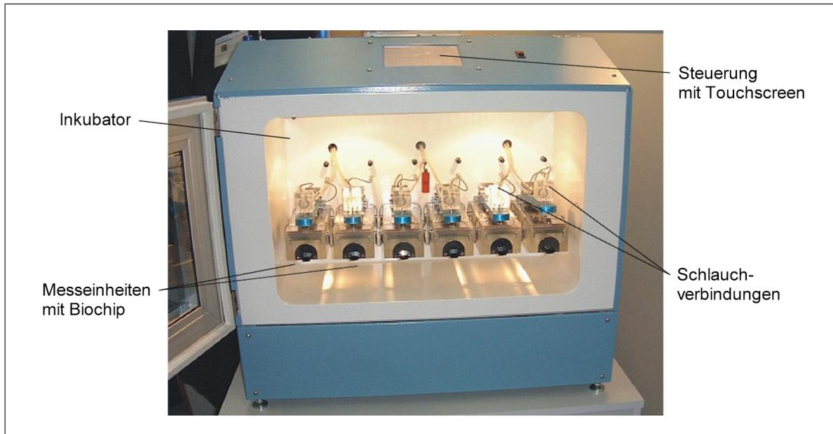
**Abbildung 3.3:** Mehrkanalmessgerät des LME zur dynamischen Untersuchung lebender Zellen. Bis zu sechs Proben können unter identischen Bedingungen automatisiert bedient und vermessen werden [22]
