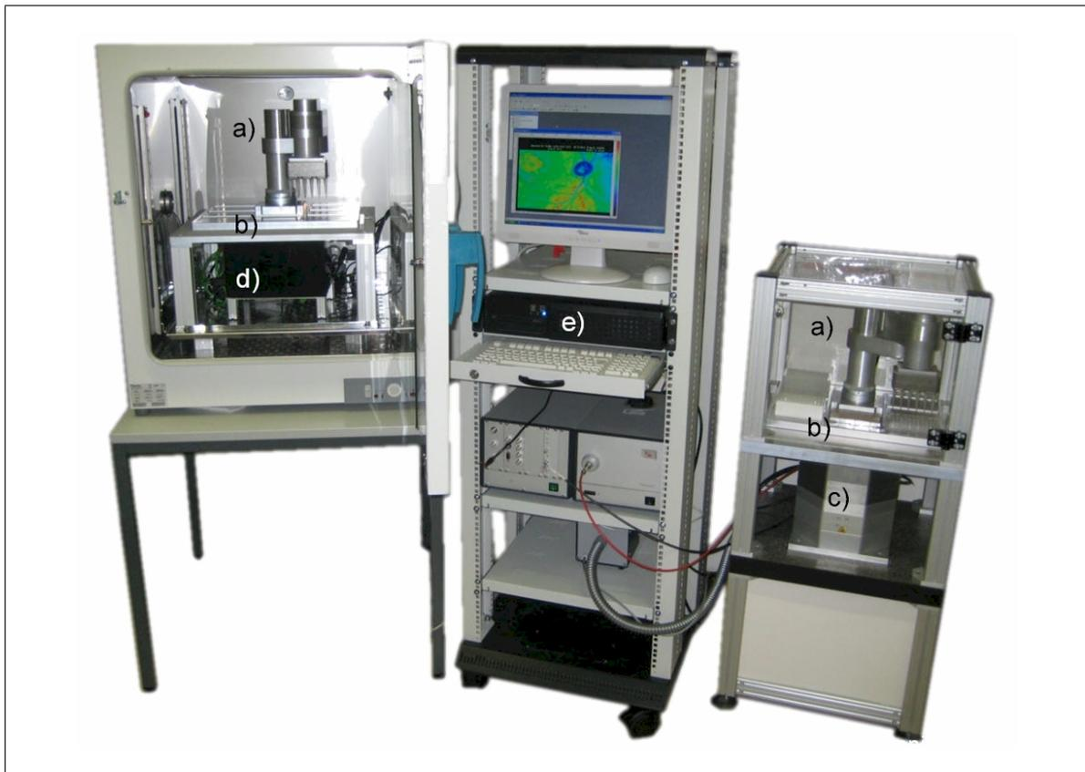
**Abbildung 8.2:** Prototypen des automatisierten Screeningsystems (zwei Ausbaustufen). a) Pipettierroboter, b) SBM, c) automatisiertes Lichtmikroskop, d) pH-pO<sub>2</sub>-optoelektronischen-Messblock, e) Steuerrechner [91]
