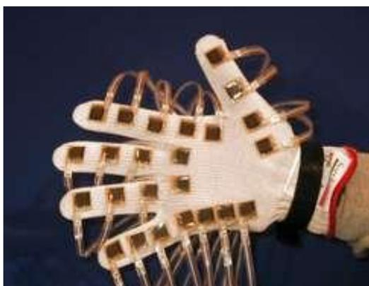
*Abbildung 3-4 Messhandschuh der Firma VISTA MEDICAL Europe, ([www.pressuremapping.com](http://www.pressuremapping.com) vom 04.03.2009)*
