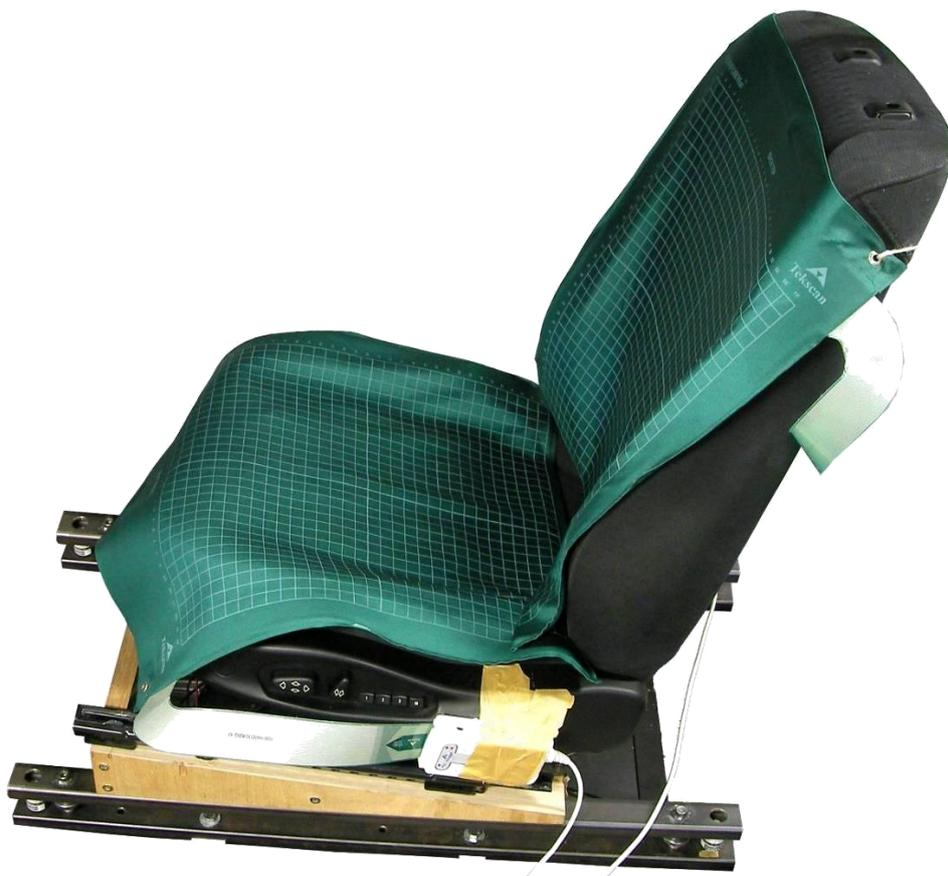
Abbildung 4-5 Messmatten der Serie CONFORMat
