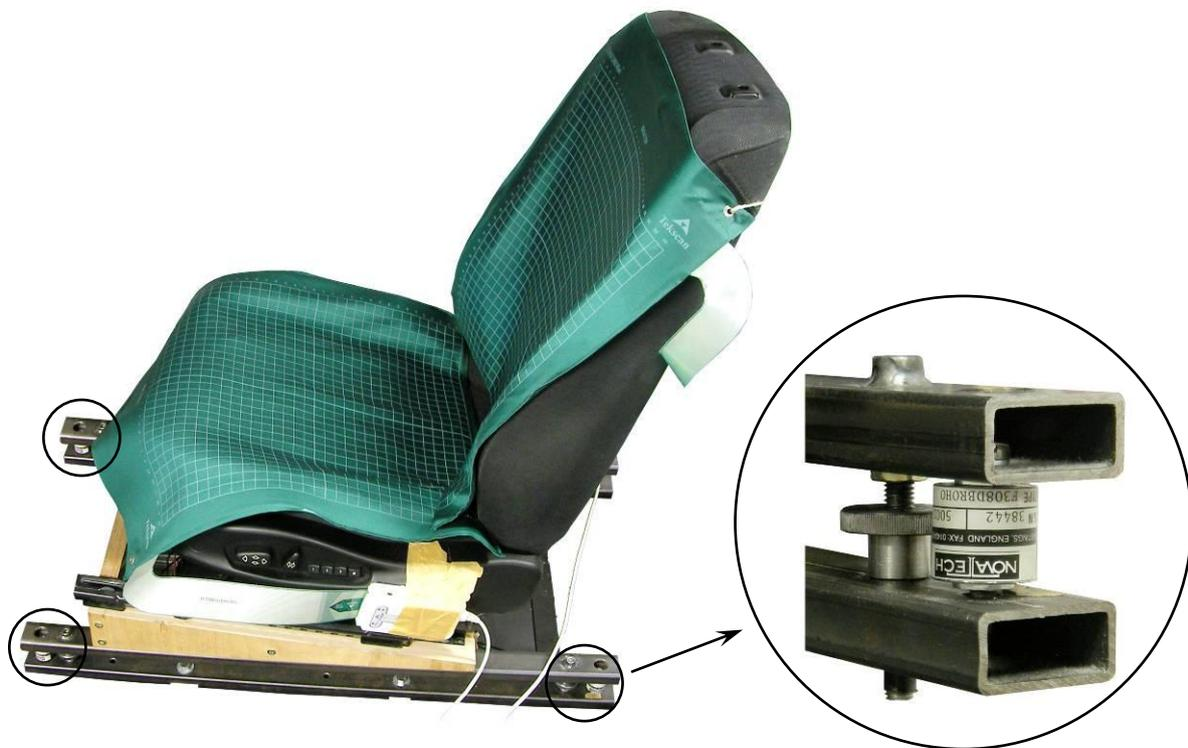
Abbildung 4-11 Sitzsensoren mit vergrößerter Darstellung der Sicherheitseinrichtung (Sensor unbelastet)
