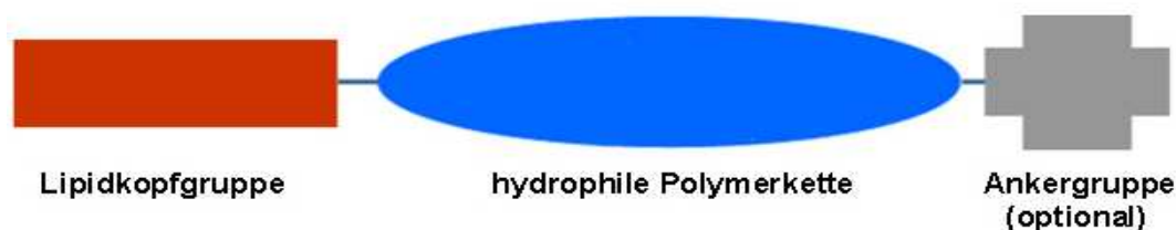
Abbildung 2.10: Struktur eines Lipopolymers zum Aufbau von polymerunterstützten Lipidmembranen.
