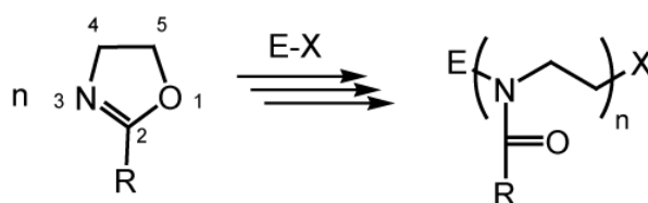
Abbildung 2.13: Struktur eines 2-Substituierten Oxazolinrings sowie dessen Umsetzung mittels eines elektrophilen Initiators zur lebenden Poly(2-oxazolin) Spezies.
