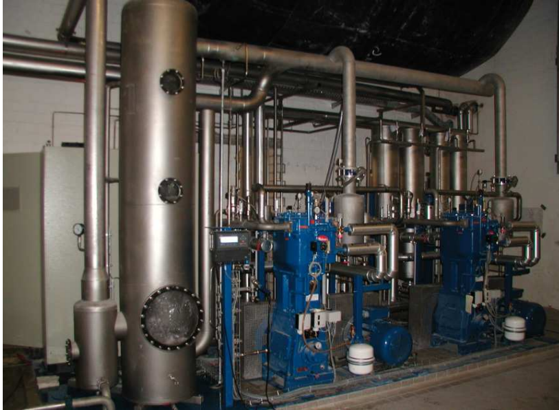
Abbildung 53: Versuchsanlage zur CO 2 -Gewinnung mit Gaswäscher, Gasballon und Kompressoren
