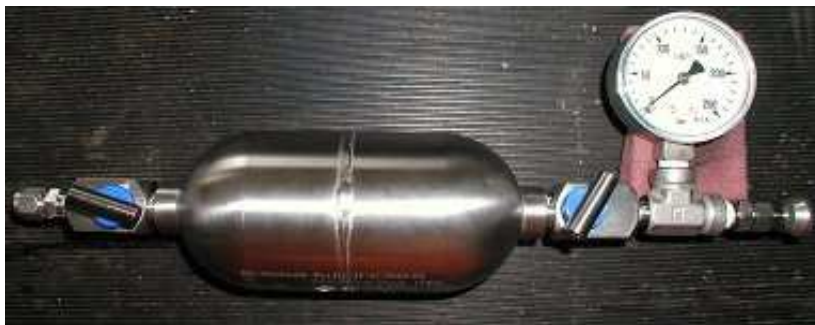
Abbildung 43: Behältersystem für Druck und Flüssig-CO 2 (Photo) [29]
