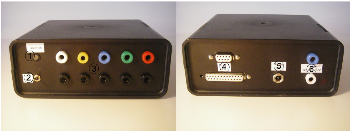
Abbildung 4.4: Frequenzgenerator: 1 Kontrollleuchte, 2 Schalter Ausgangsspannung, 3 Spannungs-Stromausgänge, 4 Serielle Schnittstelle, 5 Eingang Netzteil, 6 Eingang Triggersignal
