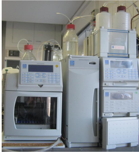
Abbildung 8: High Performance Anion Exchange Chromatography – Pulsed Amperometric Detection Anlage zur Bestimmung von vergärbaren Zuckern und Oligosacchariden
