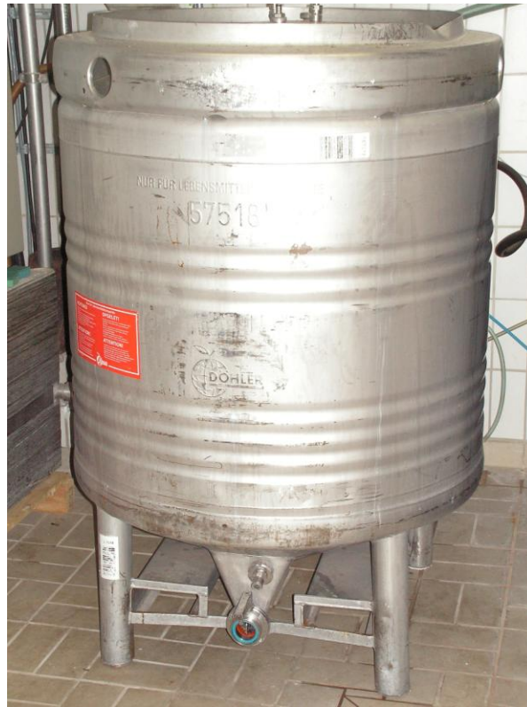
Abbildung 7: Fermentationsbehälter für Fermentationen im 500 l-Maßstab ohne Peripherie
