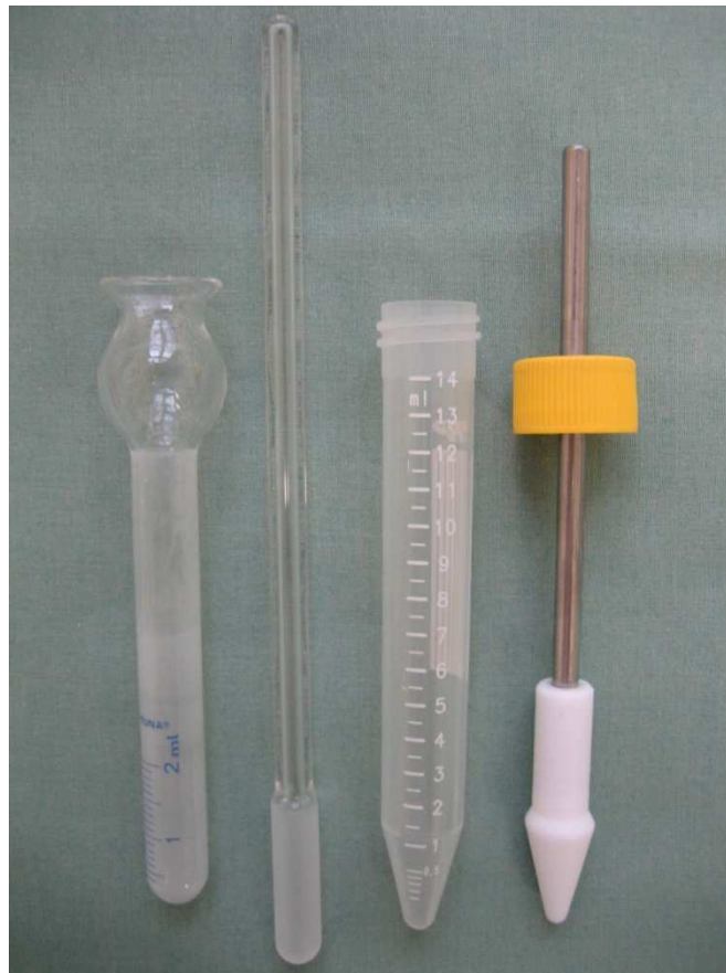
Abbildung 15: Glaspotter (links) mit Glasstößel, daneben der modifizierte Homogenisator mit dem Teflonstößel und Deckel (rechts)
