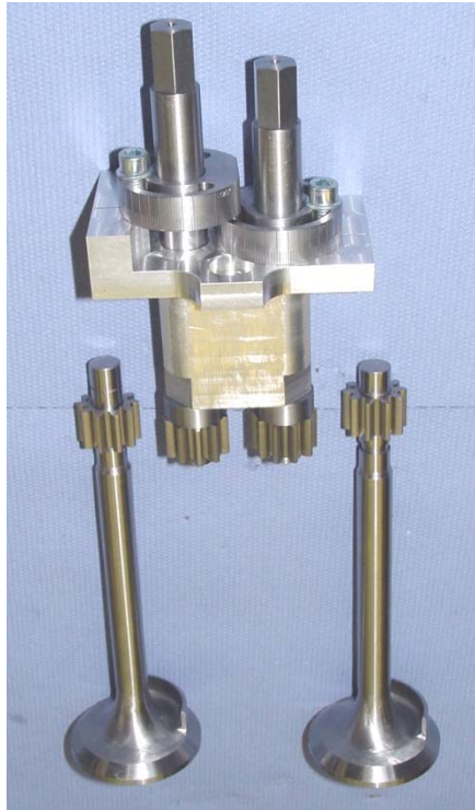
Bild 3.10: Schirmventile mit von außen bedienbarer Verstelleinrichtung
