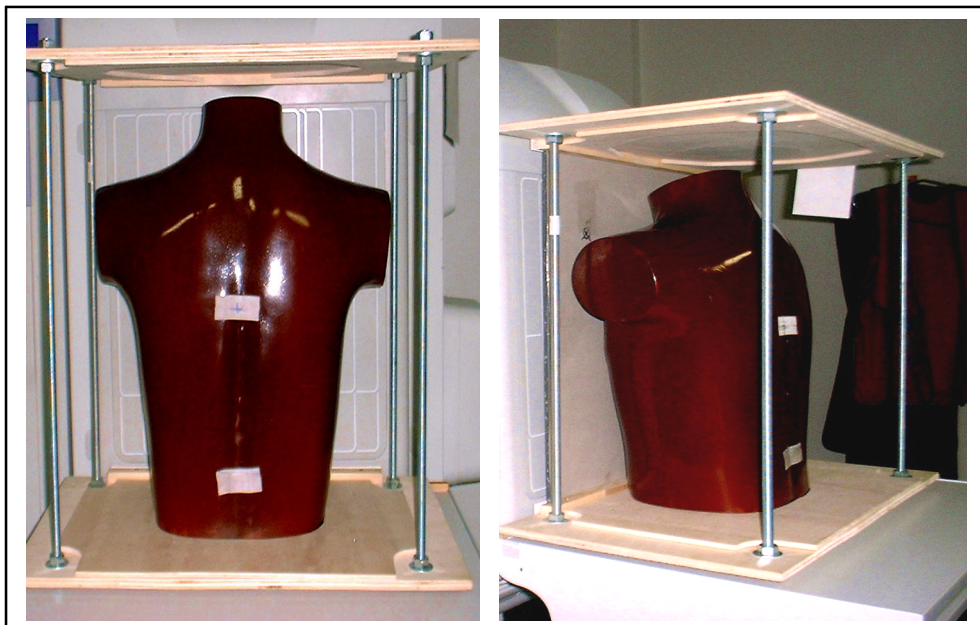
Abb. 4.7: Anthropomorphes Thoraxphantom mit Fixierungsständer für eine Plexiglasplatte
