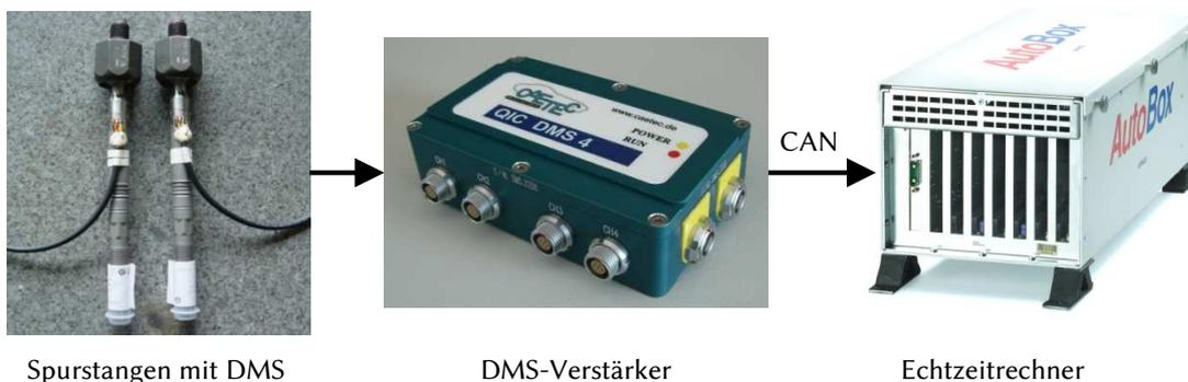
Bild 2.1: Konfiguration der Spurstangenkraftmessung (Bildquellen [30, 82])
