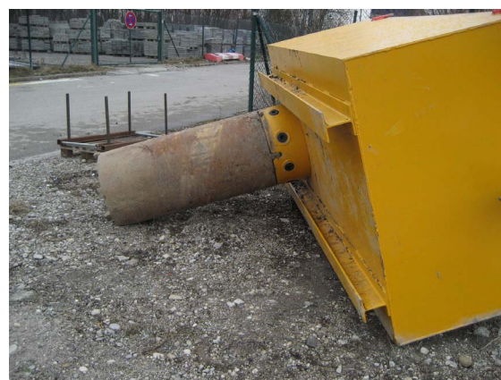
Abbildung C.10: Oberbecken Bohrloch mit angekuppelter Ansatzverrohrung
