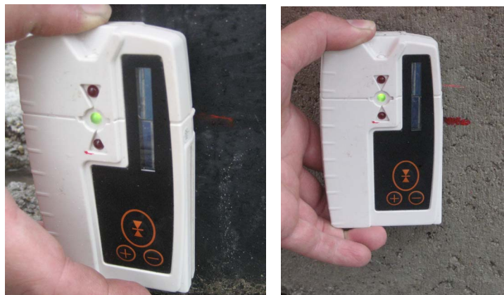
Abbildung C.52: Setzungskontrolle an den Auflagern der Messbrücken (links) und Vergleich mit Pfahlsetzung (rechts)
