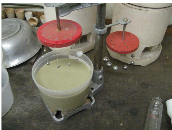
Abbildung C.45: Bestimmung der Fließgrenze der Bentonitsuspension mit Kugelharfe
