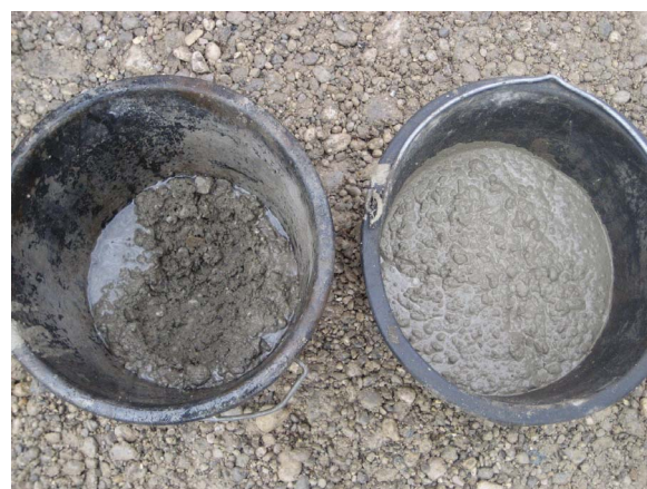
Abbildung C.40: Frischbeton vermischt mit PAA 6 g / l (links) und wie geliefert (rechts)
