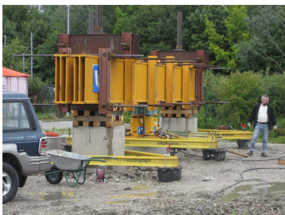
Abbildung C.49: Belastungseinrichtung und Messbrücken für Wegaufnehmer
