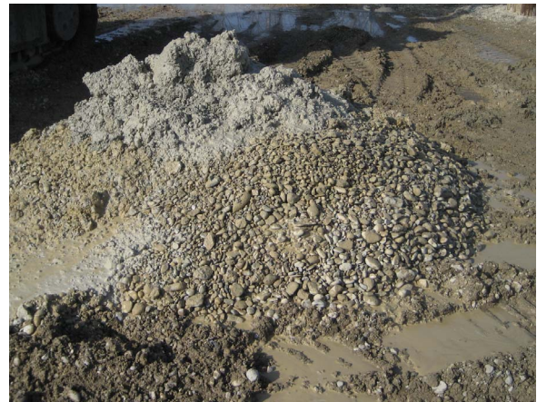
Abbildung C.28: Bohrgut (mit Rollkies)
