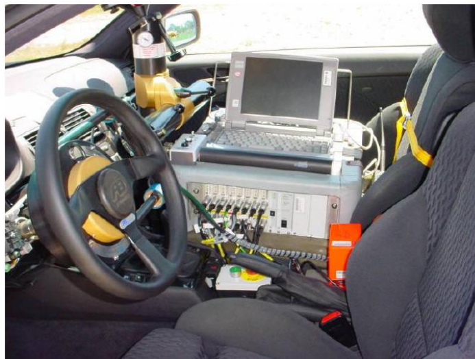
Abbildung 3.4: Lenkroboter und Messtechnik aus [23]
