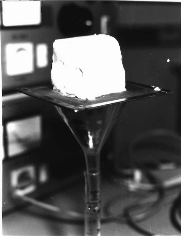
Abb. 31/8: Ausgeformter Sahnewürfel zur Bestimmung der Absetzmenge im Meßzylinder und Beurteilung der Formbeständigkeit (Ausgangsmaße des Würfels 6 \cdot 6 \cdot 6 \text{ cm}^3 )
