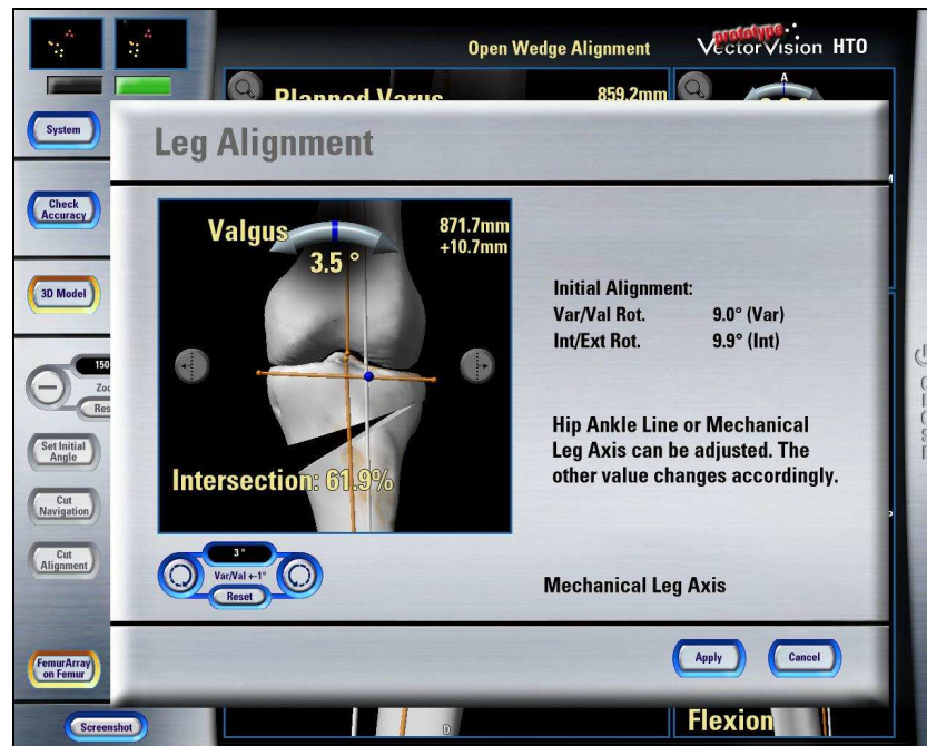
Abbildung 38 Screenshot: Vorgeschlagene Korrektur mit einem Schnittpunkt der Mikulicz Linie im Fujisawa-Punkt
