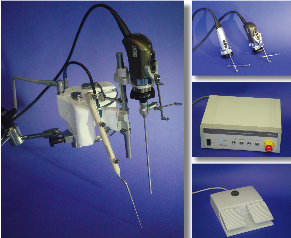
Abbildung 6.2: In Kombination mit einem medizinischen Navigationssystem kann das Endoskopführungssystem in dem Arbeitsraum der Kinematik das navigierte Endoskop so ausrichten, sodass das Instrument des Chirurgen auf dem Endoskop zentriert in der Bildmitte erscheint. Über das Fußpedal kann die automatische Nachführung freigegeben werden. Die Steuerungseinheit kommuniziert mit dem Navigationssystem, berechnet die Nachführwinkel und steuert die Motoren an.
