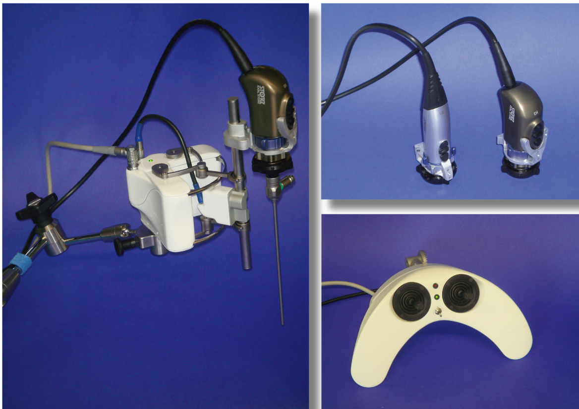
Abbildung 6.1: Endoskopführungssystem für die HNO-Chirurgie dargestellt als Telemanipulator. Die Endoskopkamera (Image1 oder Image1HD, der Fa. Karl Storz, Tuttlingen) wird intraoperativ über die Joysticks der Bedienkonsole durch den Chirurgen bei Bedarf gesteuert. In der realisierten Konfiguration lässt sich das Endoskop im Pivotpunkt schwenken und neigen sowie linear in der Tiefe verfahren. Das System ist gekennzeichnet durch seine kompakte Bauform, sein geringes Gewicht und seine situsnahe Positionierung.
