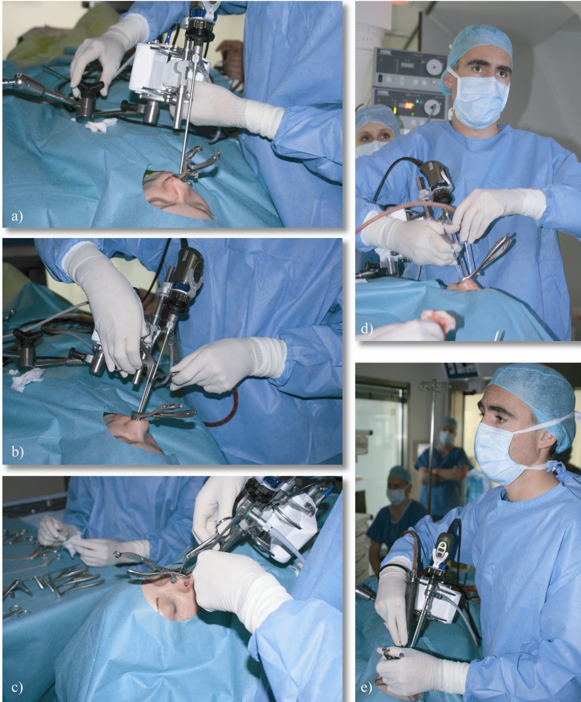
Abbildung 7.3: a) Grobausrichtung des Manipulators bzgl. der Patientennase durch den Chirurgen. b)-d) beidhändiges Führen von passiven Instrumenten. e) Führen des aktiven Instruments (Shaver) mit der dominanten Hand und Halten des Nasenspekulums mit der anderen Hand. An dem Manipulator ist die HD-Endoskopkamera mit 0° Optik befestigt (alle Bilder mit freundlicher Genehmigung von Dr. Strauß, 2010).
